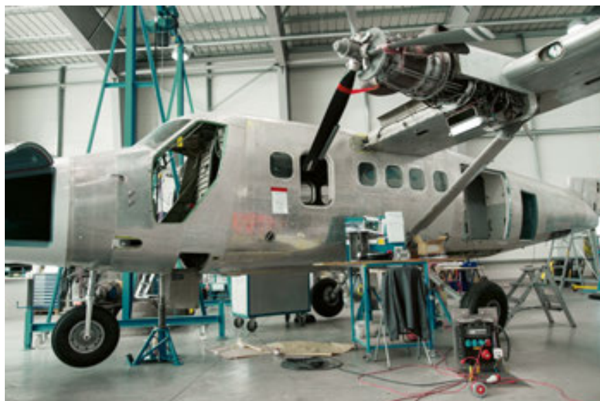
Der Unterhaltsbetrieb auf dem Flugplatz St. Gallen-Altenrhein trägt bis zu einem Viertel zum Jahresumsatz von Zimex bei. Twin Otter aus der ganzen Welt werden dort totalrevidiert.
